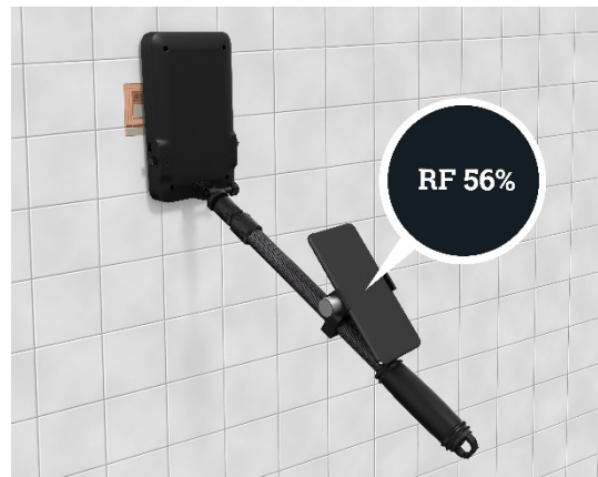
Bild 8. Invisenses skanner läser av fuktsensorn igenom de keramiska plattorna
