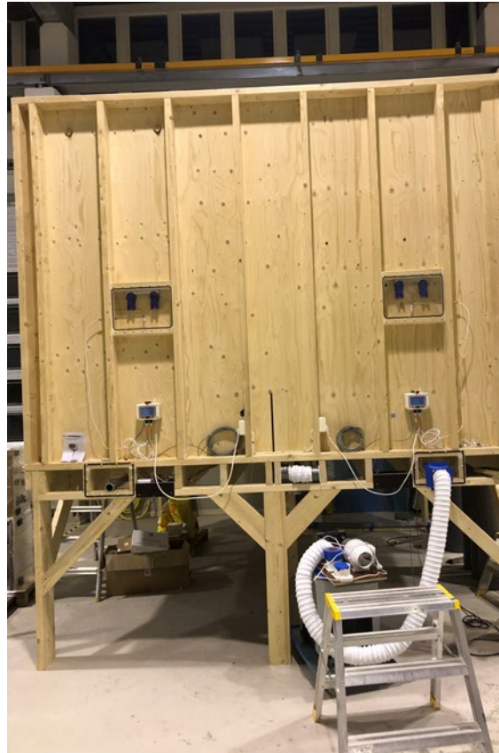
Bild 2. Foto av badrumsmock-upens utsida
