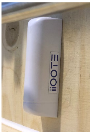
Bild 9. Fuktsensorn ELSYS Mini Sensor
